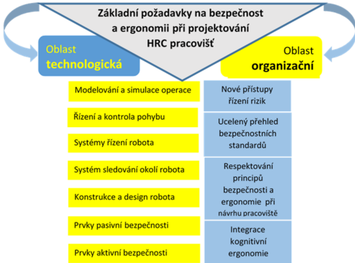
Obr. č. 4: Základní požadavky na bezpečnost a ergonomii při projektování kolaborativních pracovišť
