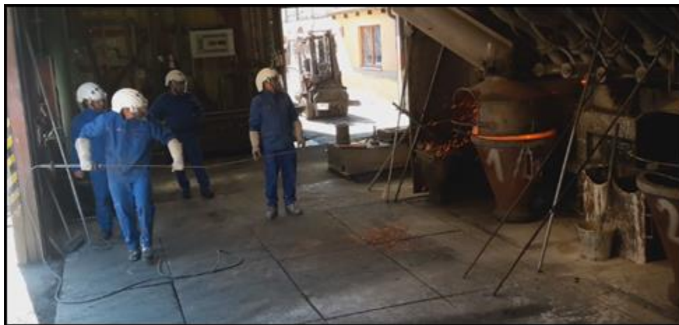
Obr. č. 6: Odpich prováděný pomocí odhořívající železné trubky. Z obrázku je zřejmé, že odhořívající železnou trubku není potřebné držet pouze v konkrétní části, ale je možné ji uchopit i dále od hadice dodávající zemní plyn. (foto: VÚBP, v. v. i.)
