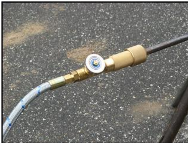
Obr. č. 12: Detail rukojeti kyslíkového kopí s použitím závitového uzávěru přívodu kyslíku. (foto: [10])
