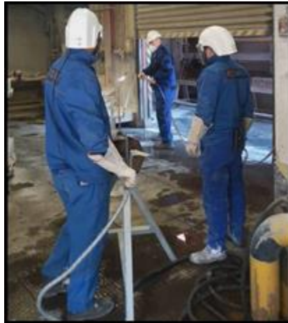
Obr. Č. 8: Zapalování kyslíkového kopí, kdy jeden zaměstnanec reguluje průtok kyslíku a druhý zaměstnanec zapaluje kopí pomocí hořáku. (Foto: VÚBP, v. v. i.)
