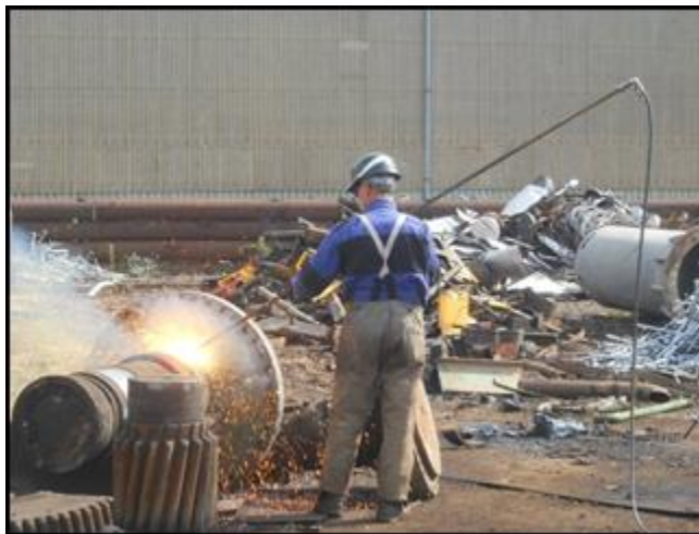
Obr. č. 10: Příklad použití kyslíkového kopí při řezání železného šrotu. Z obrázku je zřejmé, že manipulace s kyslíkovým kopím může probíhat i tak, že jej není potřeba ovládat za držadlo. (foto: [9])
