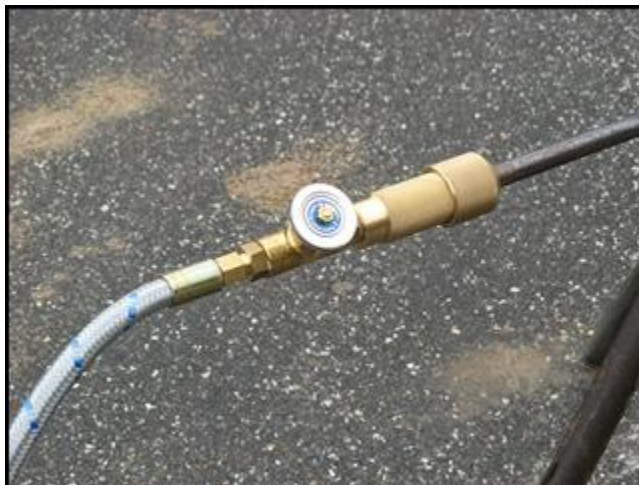
Obr. č. 12: Detail rukojeti kyslíkového kopí s použitím závitového uzávěru přívodu kyslíku. (foto: [10])
