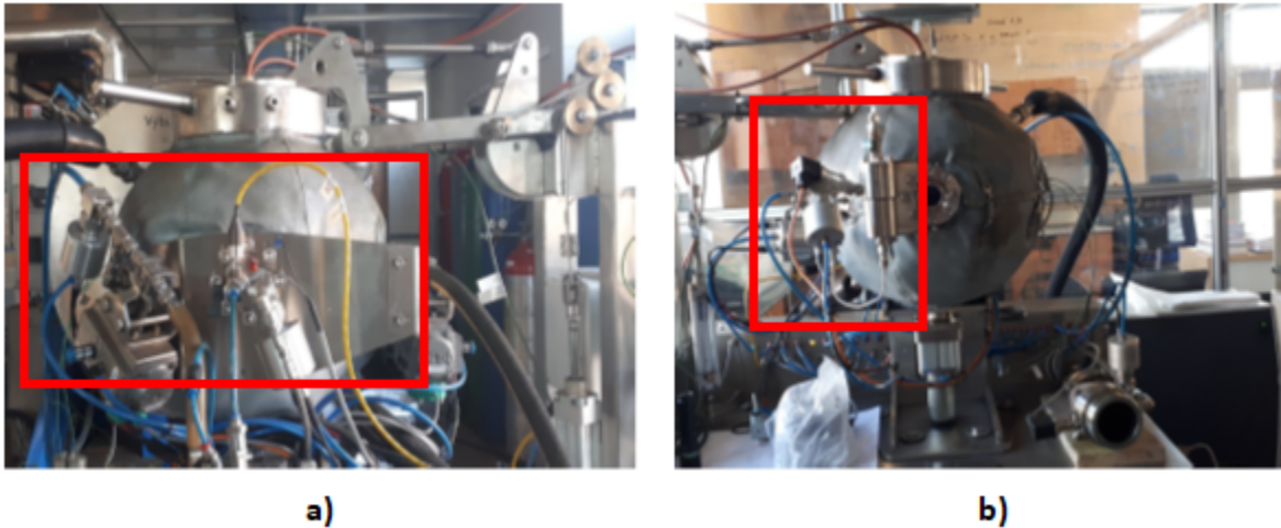
Obrázek 3: Výbuchový autokláv a) systém odsávání a provětrávání (vlevo); b) systém dávkování kapalin (vpravo)
