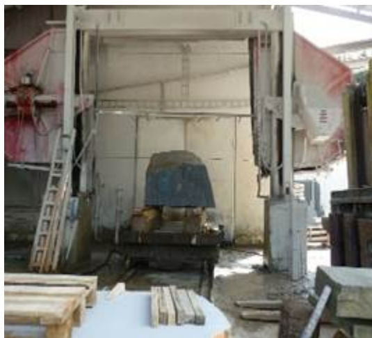
Obrázek 2: Vytěžené žulové kvádry a lanová pila
