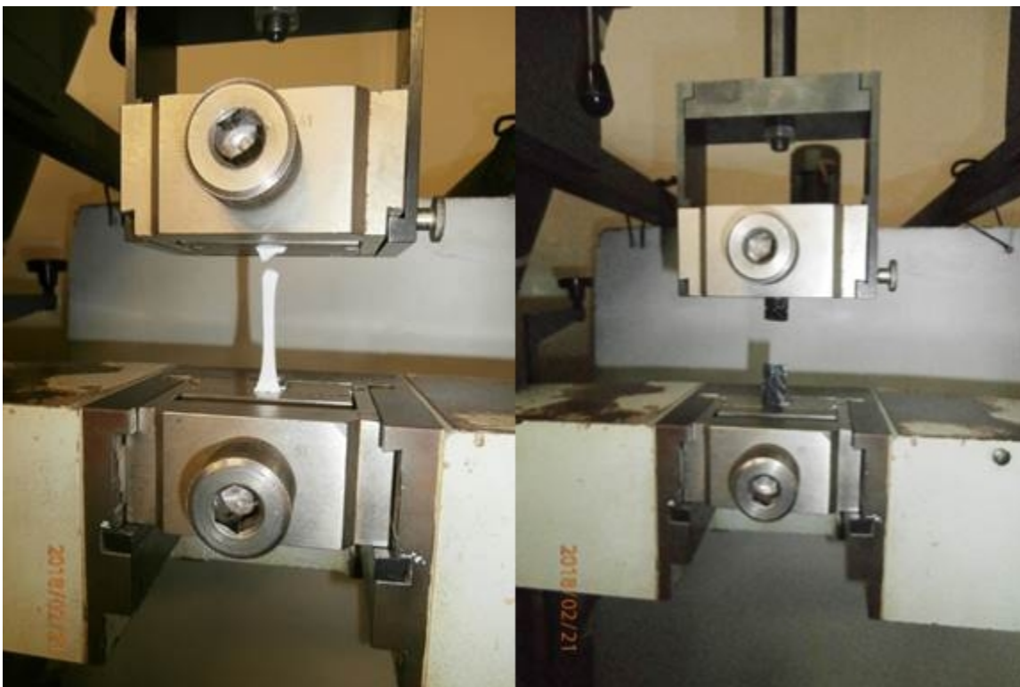
Obrázek 23: Trhací zkoušky kompozitu PDMS - biochar (5%) a nanovláknem PVB
