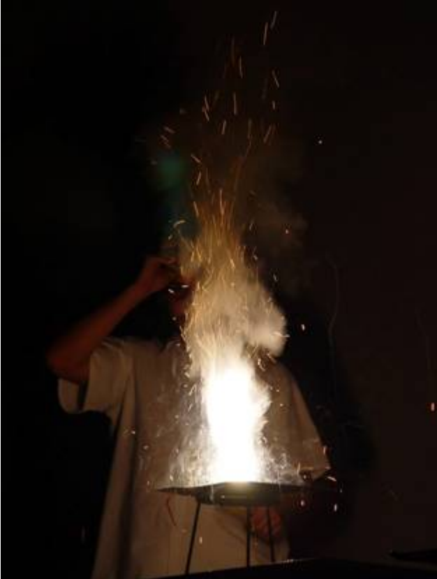
Obrázek 1: Demonstrace vzplanutí malého množství výbušnin na bázi anorganického oxidačního činidla (dusičnan draselný) ve volném prostoru. Účinnost výbušnin byla navýšena přidávkem hliníkového prachu.
