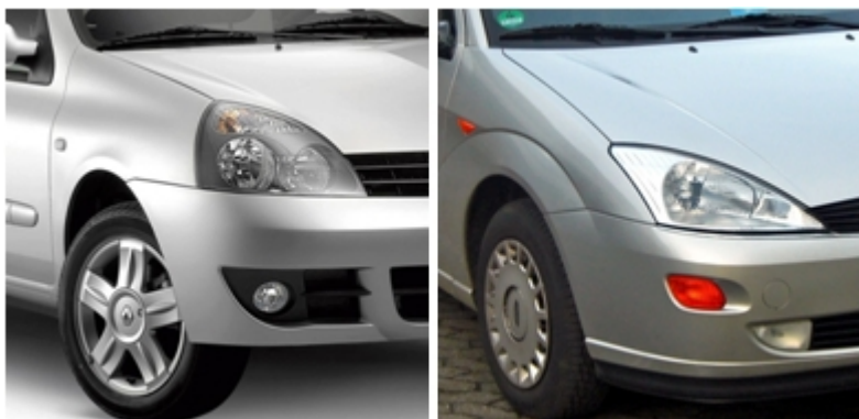
Obr. 12: Typické riešenie prechodu plôch guľatým rohom [2]
