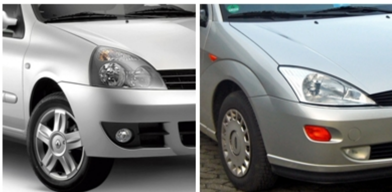
Obr. 12: Typické riešenie prechodu plôch guľatým rohom [2]
