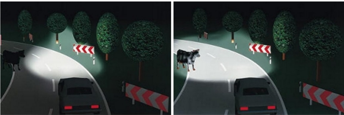
Obr. 7: Klasické svetlá (vľavo), zákrutové svetlá (vpravo) kužeľ smeruje v smere predpokladanej trasy [8]
