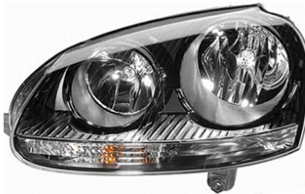
Obr. 2: Parabolický svetlomet s viacnásobnou odrazovou plochou [4]
