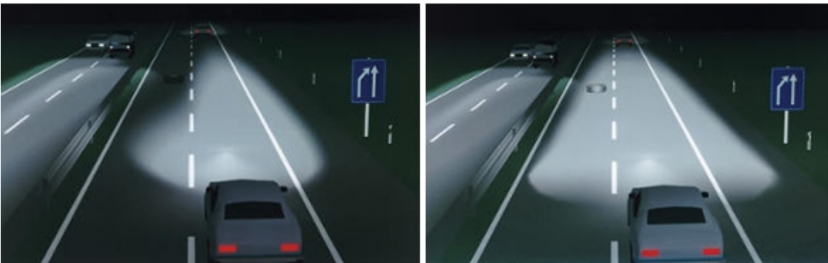
Obr. 8: Klasické svetlá (vľavo), diaľničné svetlá (vpravo) dlhší dosah a rovnomernejšie osvetlenie vozovky [8]
