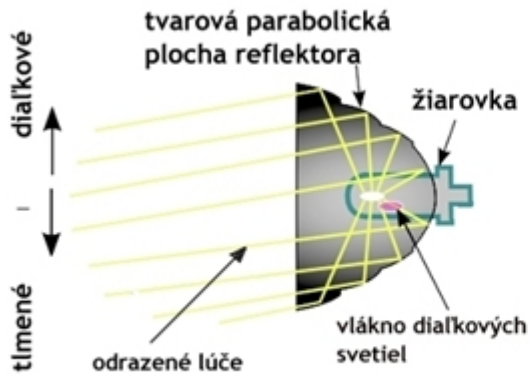
Obr. 2: Parabolický svetlomet s viacnásobnou odrazovou plochou [4]
