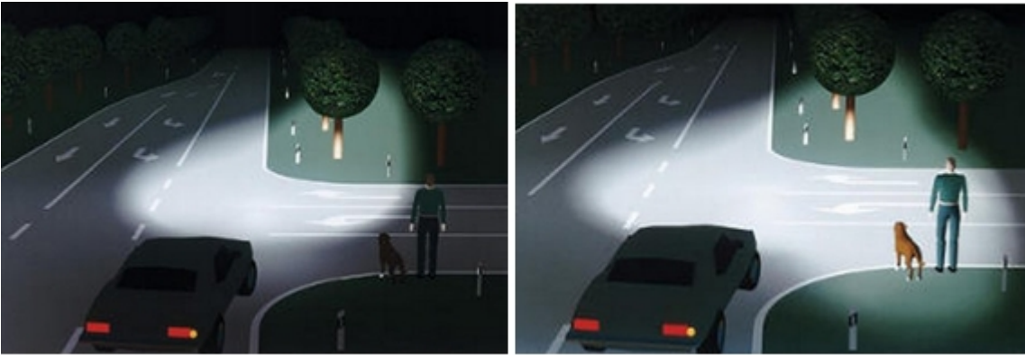
Obr. 6: Klasické svetlá (vľavo), odbočavacie svetlá (vpravo) natáčajú sa do strany [8]
