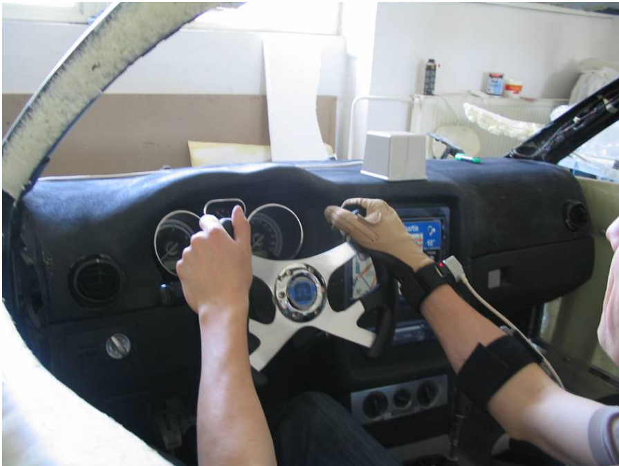
Obr. 3: Študentský automobil - snímanie reálnych pohybov pri ovládaní volantu pomocou dátovej rukavice [12]
