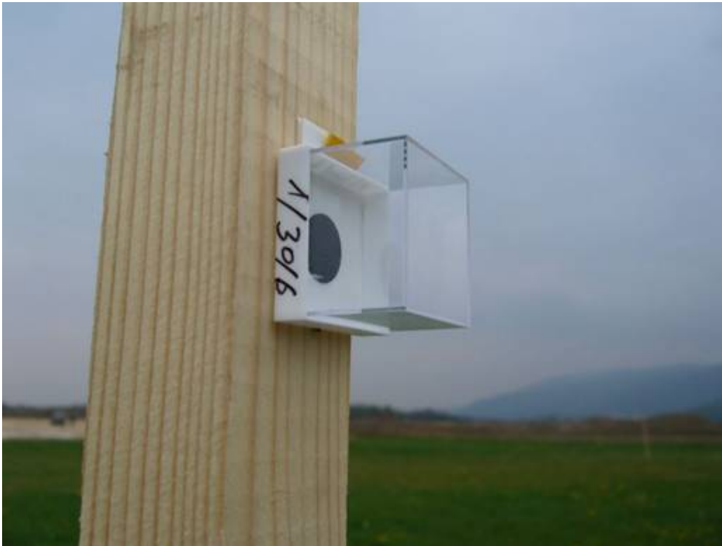
Obrázek 11: Pohled na pasivní detektor (detektor je po sejmutí plastového víčka připraven k expozici); Autor: Tomáš Vítek.
