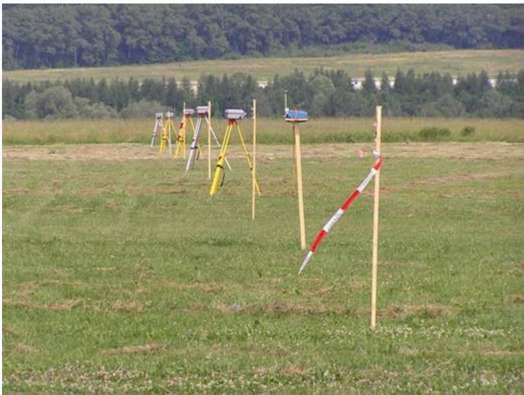
Obrázek 13: Rozmístění aktivních detektorů DustTrak; Autor: Petr Skřehot.
