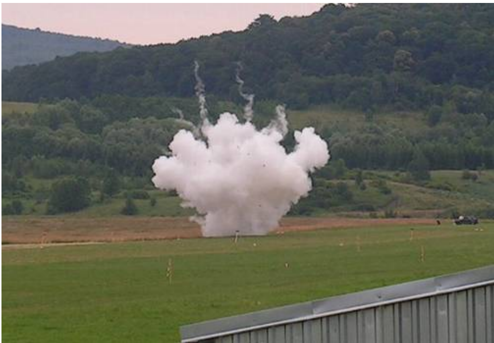
Obrázek 16a, 16b: Tvary oblaků cca 1 sekundu po výbuchu při použití různých výbušnin; Autor: Petr Skřehot.
