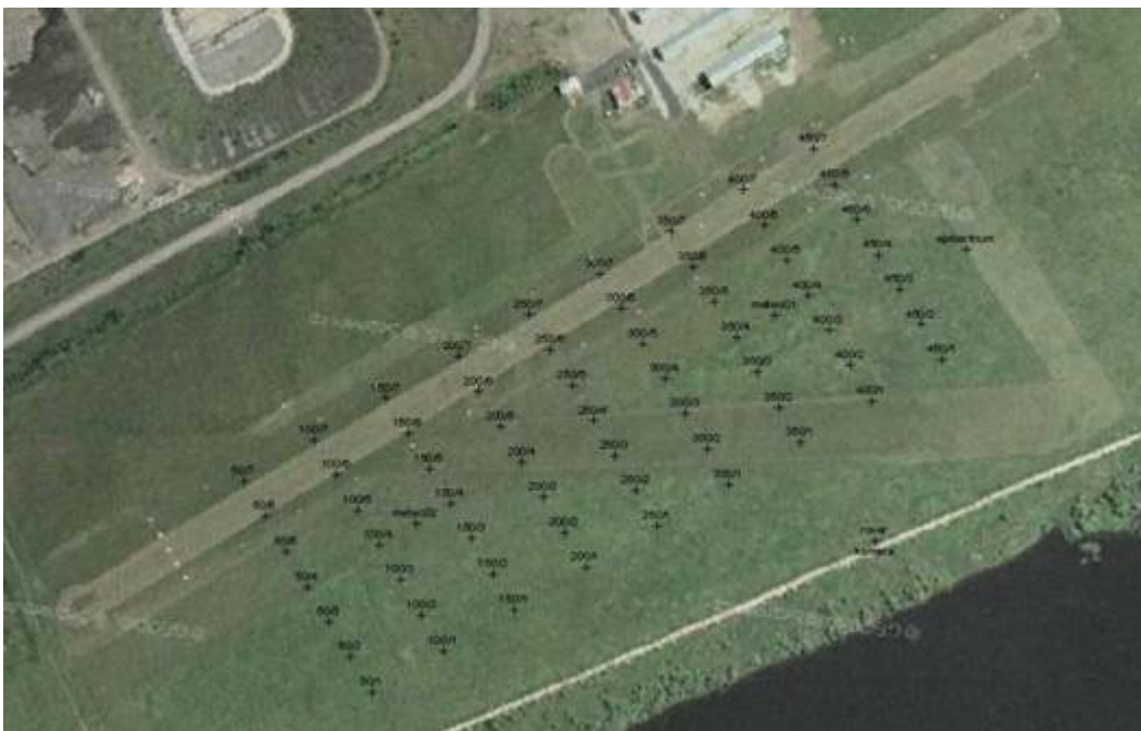
Obrázek 12: Vizualizace tvaru detekční sítě a rozmístění jednotlivých terčů, meteorologických stanic a epicentra výbuchu; Autor: Slavoj Zemánek.
