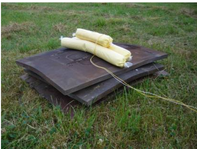
Obrázek 9: Výbušný systém před umístěním křemenného písku; Autor: Michaela Havlová.
